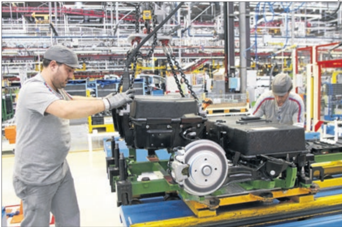
Dos operarios colocan las baterías de una furgoneta eléctrica en la cadena de montaje.
